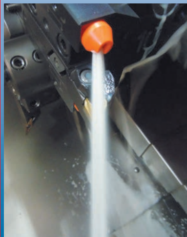
Konzentrierte Kühlmittelezufuhr zur Schneide Concentrated coolant supply to the edge
